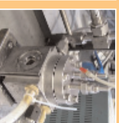
Apparato sperimentale per misure di diffrazione in condizioni di reazione.
